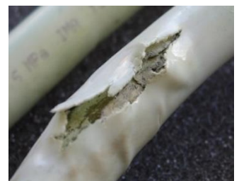
外面亀裂発生例 (当協会 会員製品)
