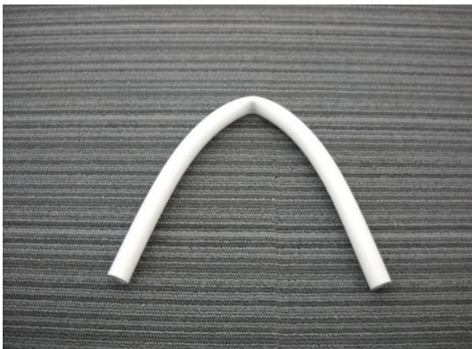
パイプの折れ(キンク)
