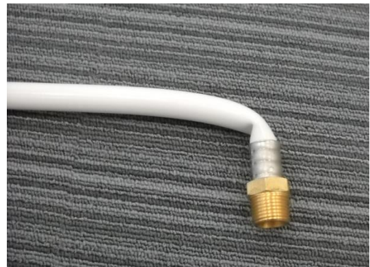
継手部近傍の座屈
