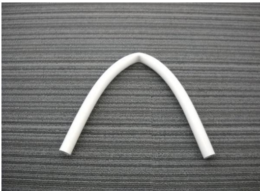
パイプの座屈(キンク)
