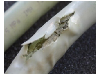
外面亀裂発生例 (当協会 会員製品)
