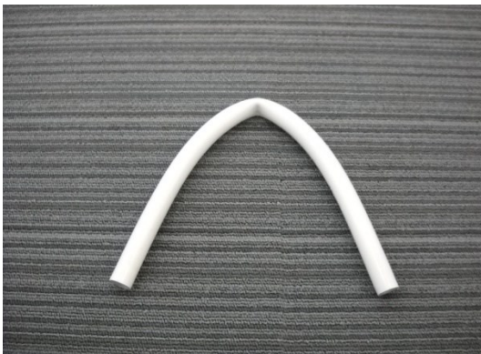
パイプの折れ(キンク)
