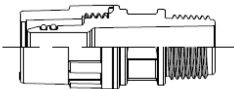
g) 拡張した管をナットで締め付けて水密性を確保する継手
